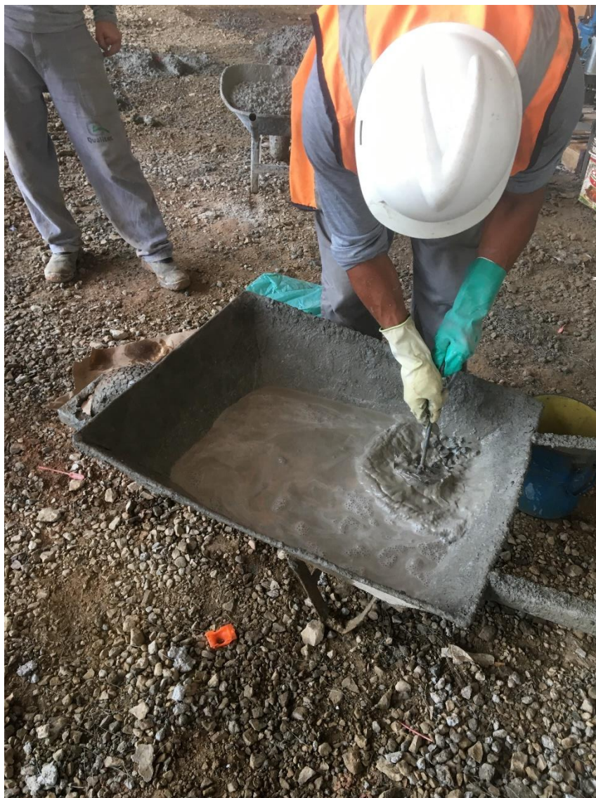
Figura 49 - Separação das fibras metálicas através de aproximação por imã
