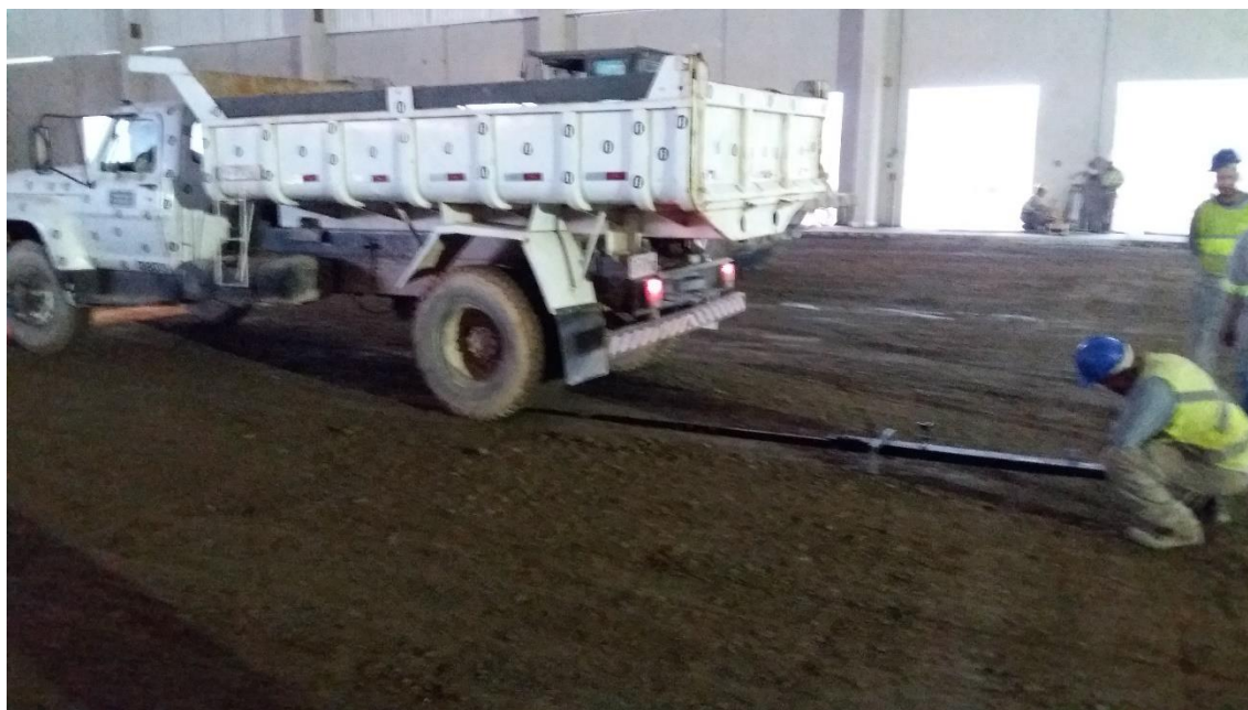
Figura 46 - Aplicação do Método Viga Benkelman.. Fonte: Do autor
