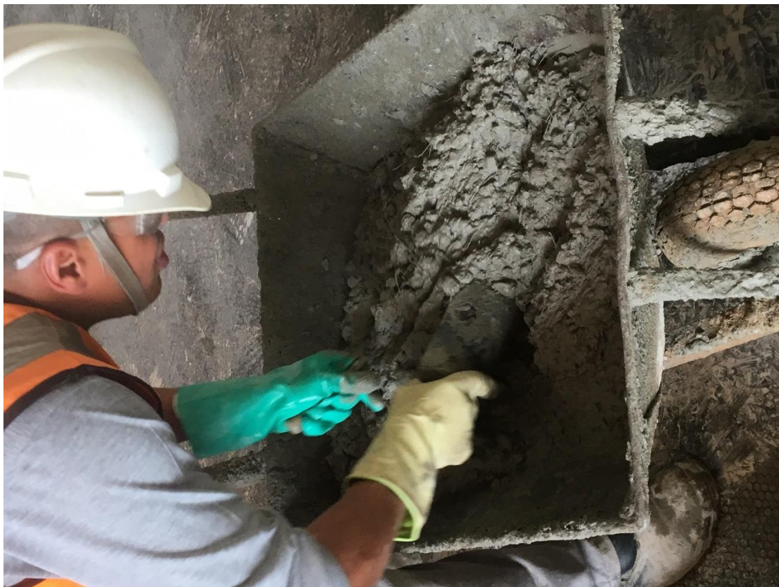
Figura 47 - Obtenção da porção inicial da massa de concreto com fibras.
