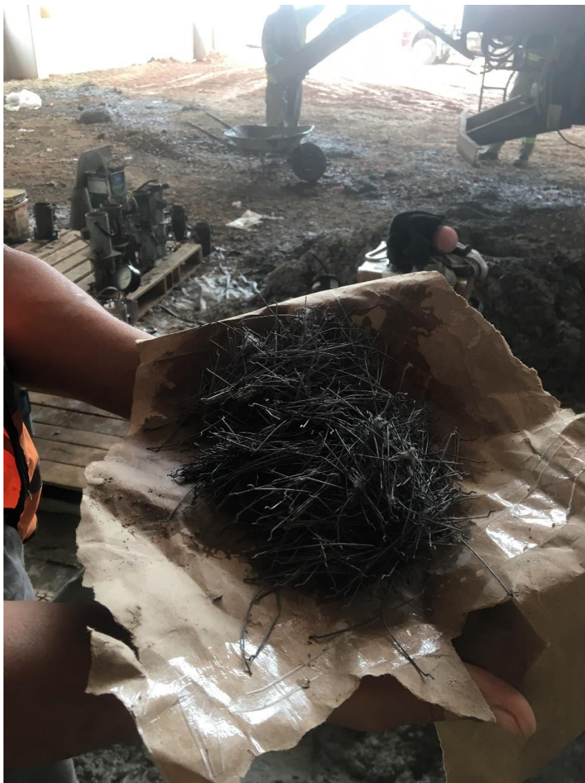
Figura 50 - Fibras separadas e pesadas
