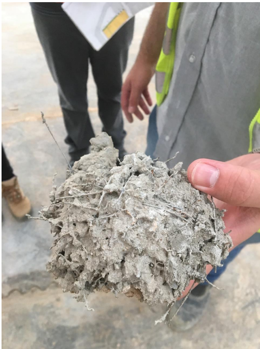
Figura 62 - "Ouriço" presente na massa de concreto
